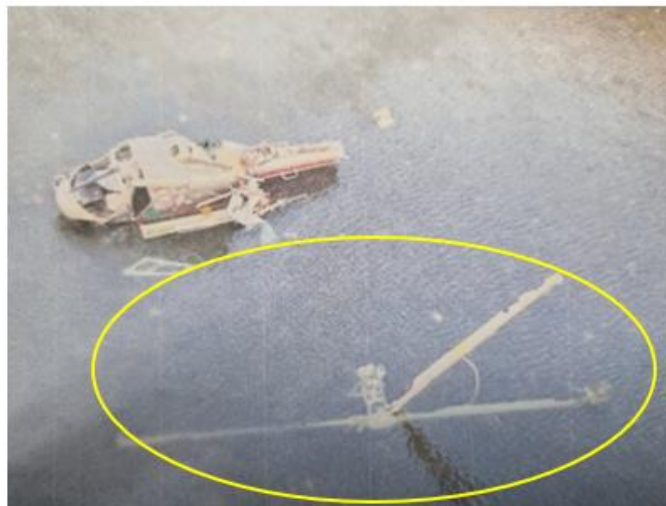
Fotografía N°2: Aeronave en Rio Duqueco, rotor principal desprendido.
