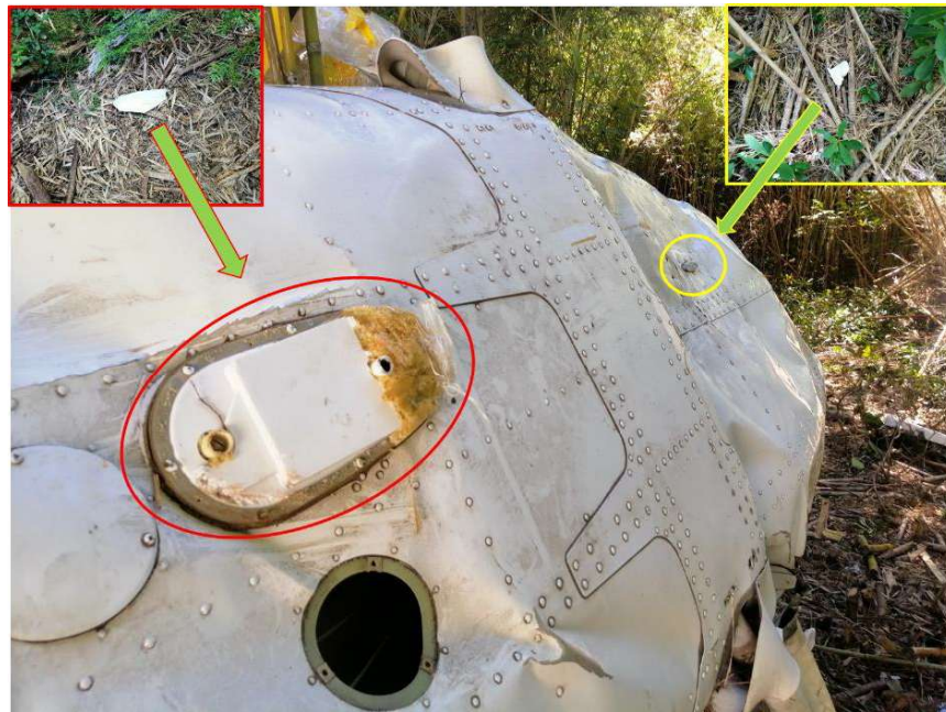
Fotografía N°24: Ubicación de la antena del Transponder (círculo amarillo) y de la antena ADF (círculo rojo), en la parte inferior de la aeronave.
