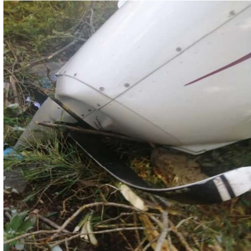
Fotografía N°13: Vista de una de las palas de la hélice, doblada hacia atrás.
