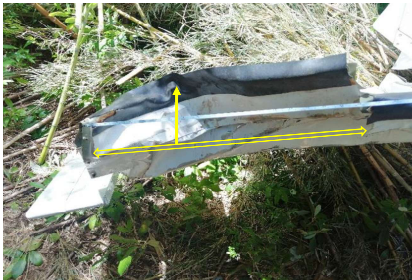
Fotografía N° 17: Vista frontal del estabilizador horizontal del lado derecho.
