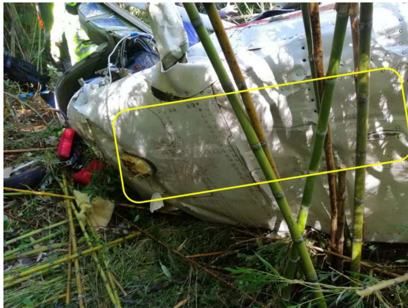
Fotografía N°26: Vista de la parte inferior de la aeronave, desde la parte posterior, hacia la cabina, con las huellas del arrastre de la aeronave, previo al impacto.
