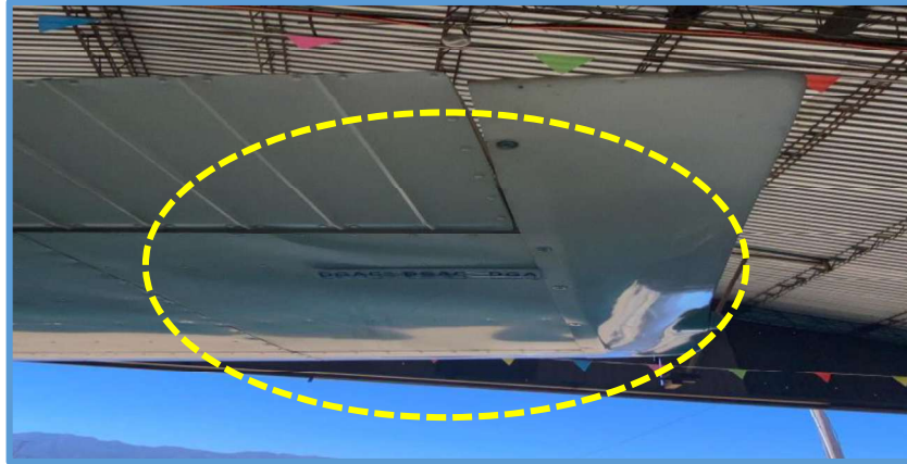
Fotografía N° 11: Vistas de los daños del ala derecha.
