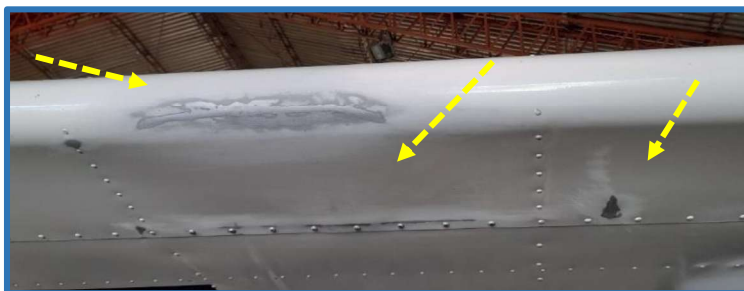
Fotografías N° 4, 5 y 6: Vistas de las marcas de roce en el borde de ataque y parte inferior del ala izquierda.
