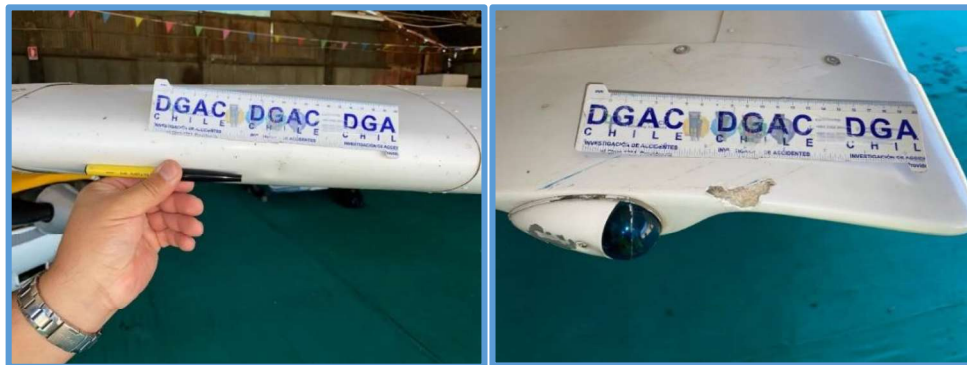
Fotografías N° 9 y 10: Vistas de los daños del ala derecha.
