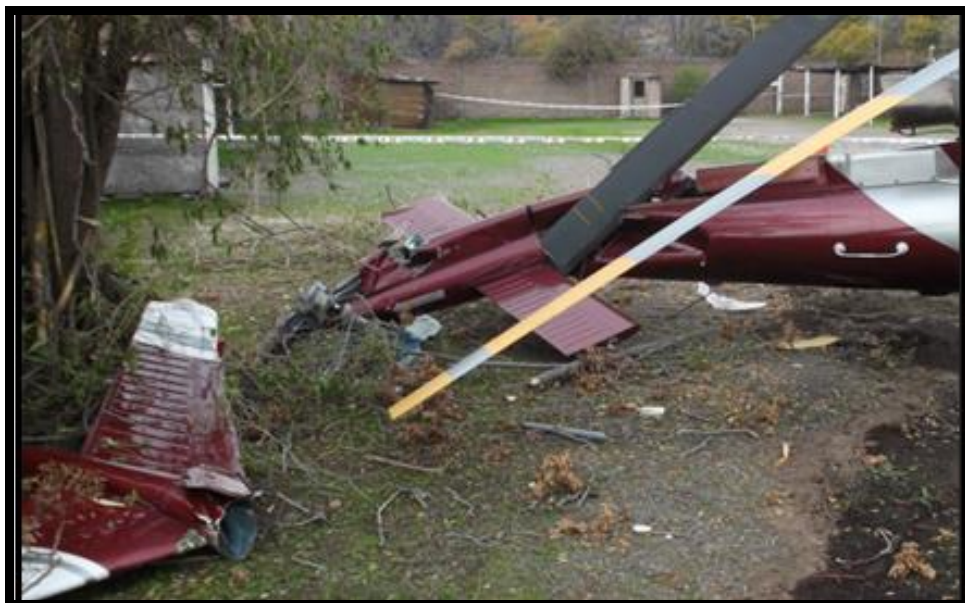
Fotografía N°4: Vista de los daños en el cono de cola.
