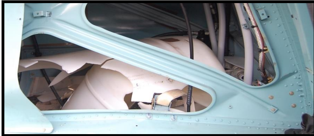
Fotografía N° 1: Vista del estanque de combustible de material plástico.
