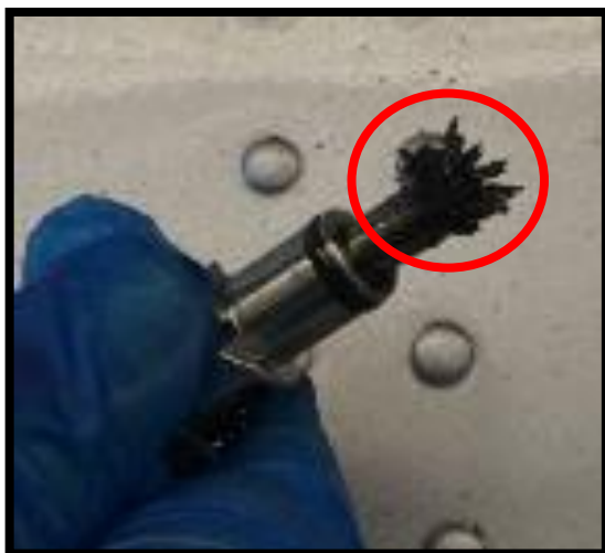
Fotografía N° 5: Tapón magnético con partículas ferrosas.
