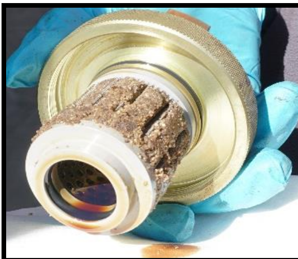
Fotografía N° 6: Filtro de aceite del motor, contaminado.
