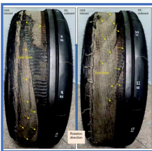
Fotografías N° 8 y 9: Daños en la banda de rodaje del neumático y sentido de rotación.
