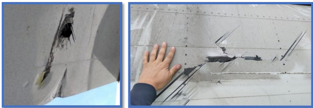
Fotografías N° 5 y 6: Vistas de recubrimientos del flap interior izquierdo, con daños estructurales.
