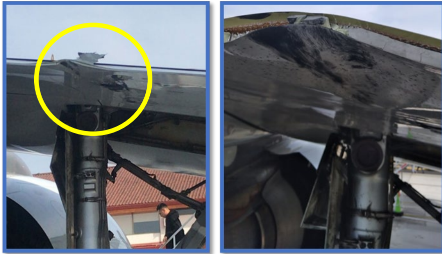
Fotografías N° 3 y 4: Vista posterior, flap interior izquierdo, con daños estructurales.
