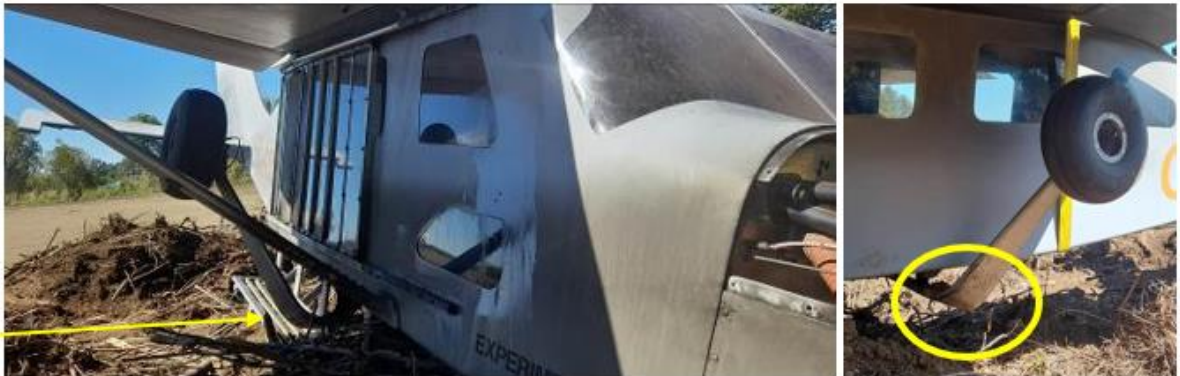
Fotografías N°11 y 12: Vistas del tren principal doblado.
