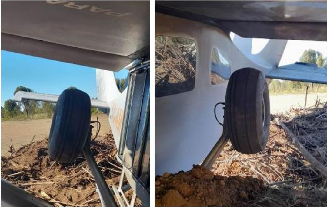
Fotografías N°13 y 14: Vistas de los neumáticos del tren principal.
