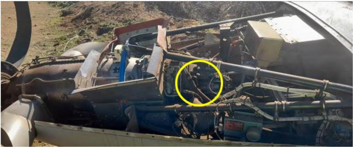
Fotografía N°21: Vista de la ubicación del Starter Generator.
