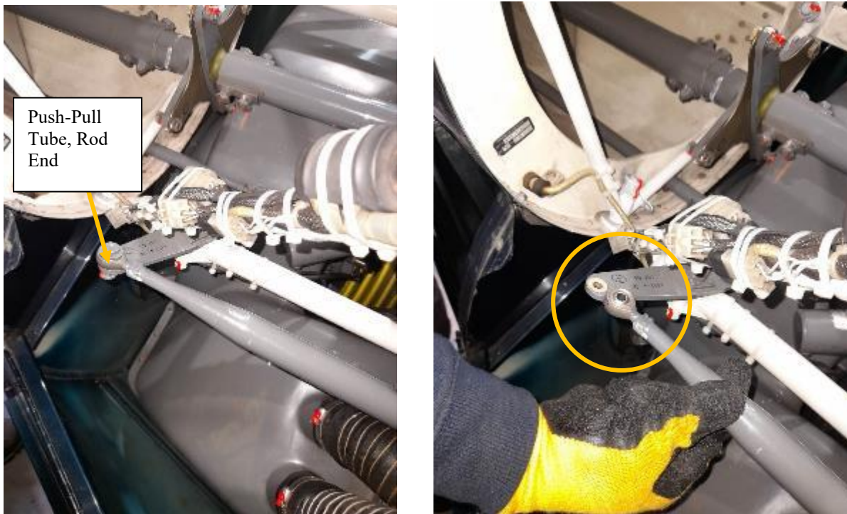
Fotografías 32 y 33: Vistas de la desconexión del Rod End.
