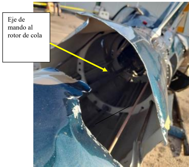
Fotografías 11, 12 y 13: Vistas de la fractura del cono de cola
