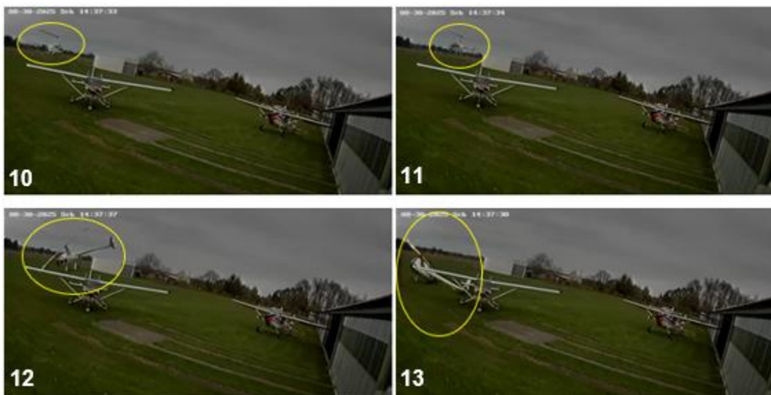
Imagen N° 10 a la 13: Secuencia de la pérdida de control del helicóptero (IGE), frente a los hangares.
