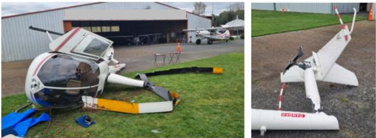
Imagen N°4 y 5: Deformaciones y fracturas en conjunto de palas del rotor principal, cono de cola y rotor de cola.
