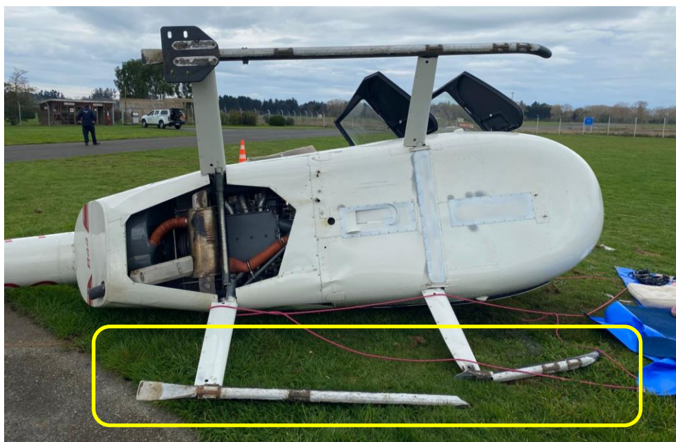
Imagen N°8: Fractura tren de aterrizaje tipo SKID.
