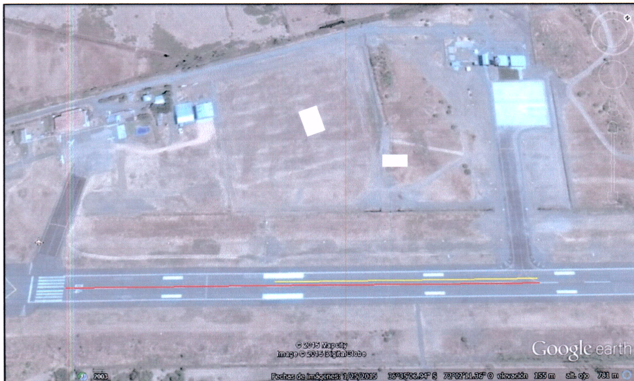
Fotografía 1: Distancias recorridas por la aeronave, en su rodaje (línea roja, 540 metros) y carrera de despegue (300 metros, de acuerdo a lo relatado por el piloto).
