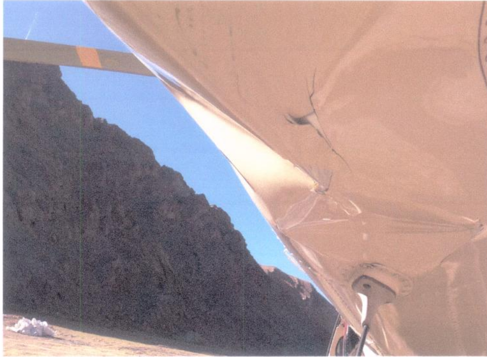
FOTOGRAFIA N° 3: Se distingue fractura del revestimiento de cola en zona posterior de antena VHF.
