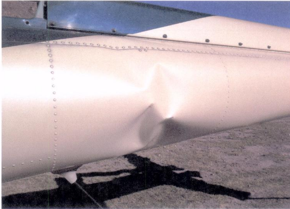
FOTOGRAFIA N° 1: Se distingue deformación, debido a cargas de compresión.
