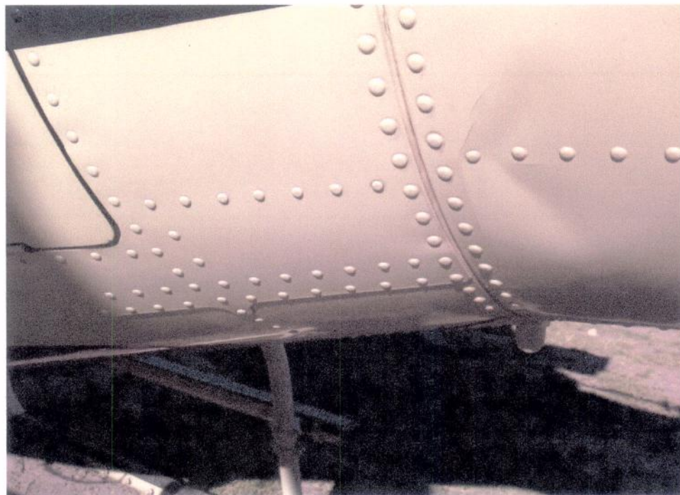
FOTOGRAFIA N° 4: Se aprecia el pandeo de la estructura del cono de cola en la zona de unión al fuselaje central.
