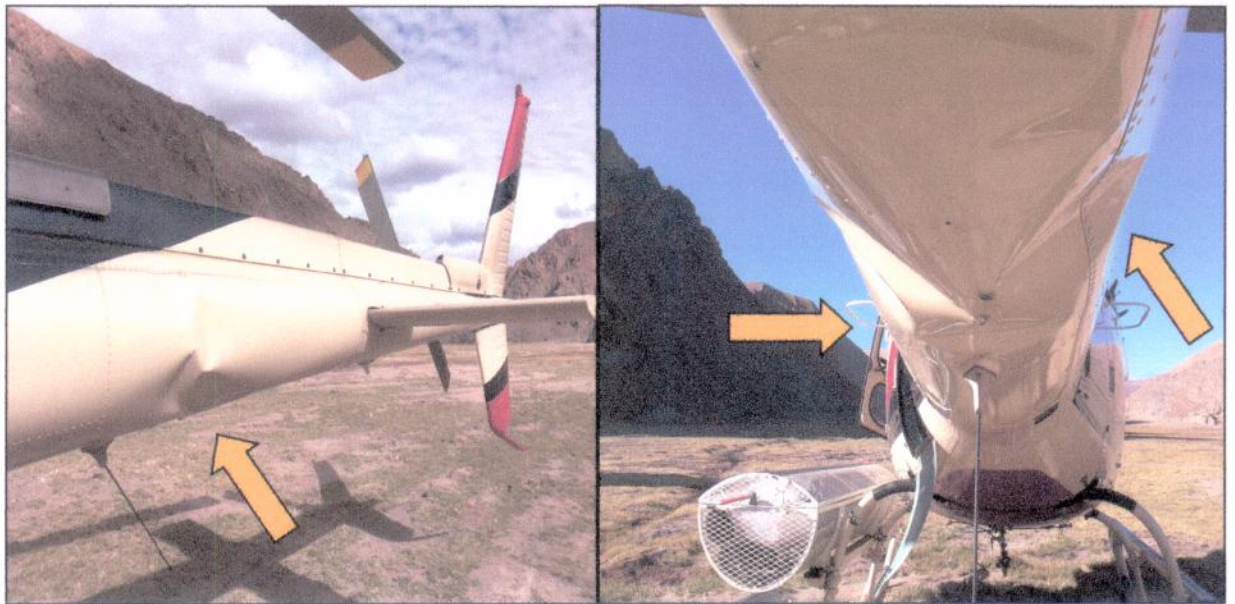
Fotografías 1 y 2: Daños del cono de cola.
